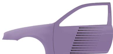
Applicare 1-2 mani ad effetto a pressione d'ingresso ridotta a 1,0 - 1,5 bar per produrre una transizione graduale. Appassimento.
