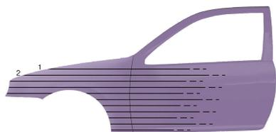
Spruzzare l'area su cui è stato applicato il colore di fondo con il primo strato di mano effetto e lasciare appassire. Estendere l'area di applicazione con una seconda mano e asciugare (ripetere se necessario per la precisione del colore).
