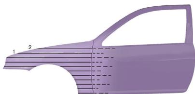
Spruzzare l'area su cui è stato applicato il surfacer con il colore di fondo. Applicare in mani singole con appassimento intermedio. Estendere leggermente ogni mano in modo da formare un film opaco.
