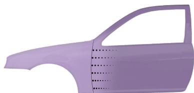
Dopo l'appassimento applicare un'ulteriore mano leggera ad una pressione ridotta per creare una transizione graduale. Appassimento (preferibile 5-10 minuti a 60-65 ° C).
